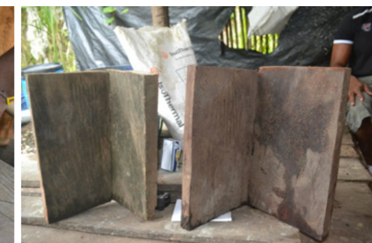
3 Patas construidas con tablas pegadas en forma triangular
