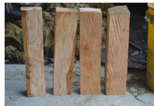
1 Patas de guayacán de 35 centímetros de largo
