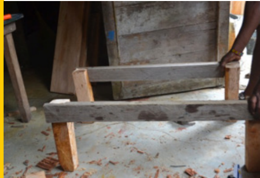
7 Soportes de la base del fogón terminados con patas de guayacán
