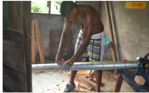
43 Proceso de medir el tubo
