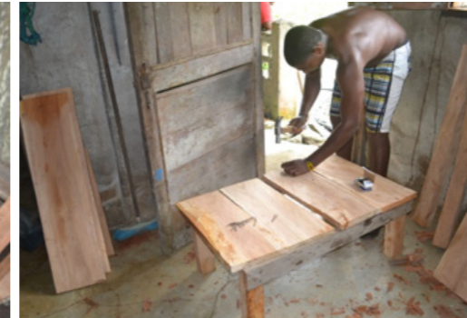
9 Pegando las tablas al soporte de la base del fogón
