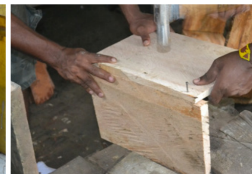
2 Armado de las patas con tablas
